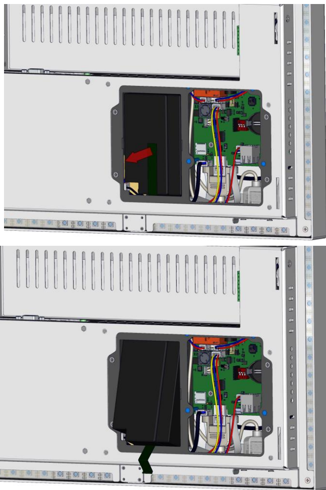
Рисунок 9.2.4 Схема демонтажа АКБ
